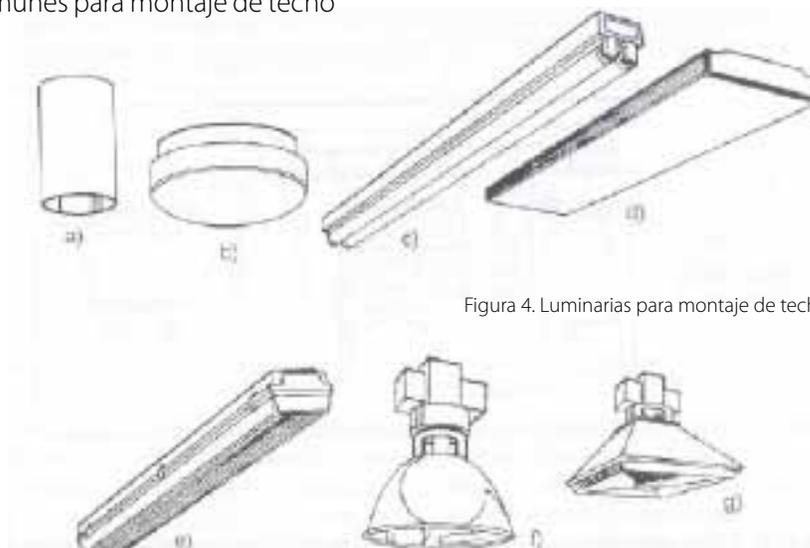
Figura 4. Luminarias para montaje de techo.
