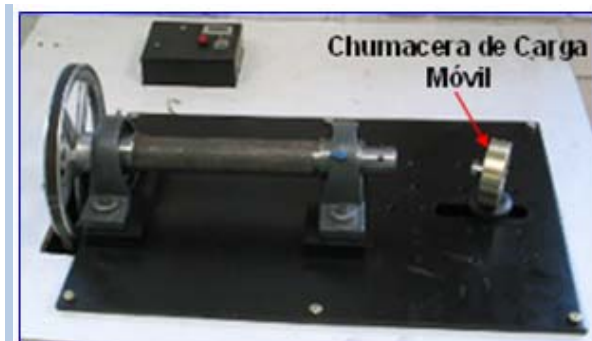
Figura 9: Chumacera móvil de carga (sin probeta).
