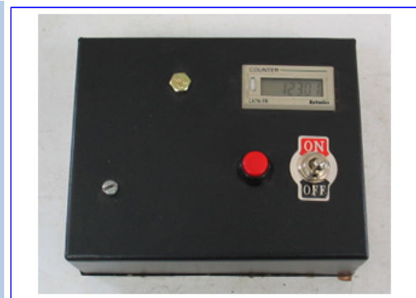
Figura 8: Contador digital de ciclos e interruptor principal
