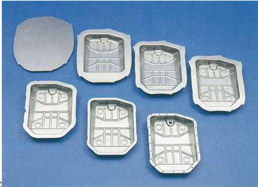
Figura 13. Pieza Embutida en varias etapas
