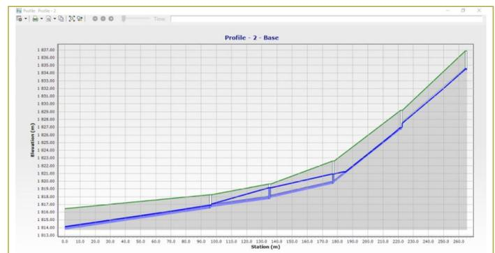
**Figura 19.** Modelo de alcantarillado en un escenario crítico.
