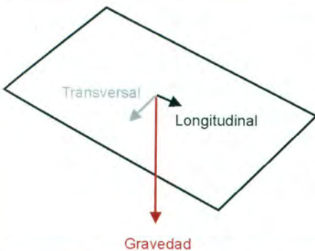
Figura 12. Descomposición de la gravedad en los dos ejes de interés para el acelerómetro.
