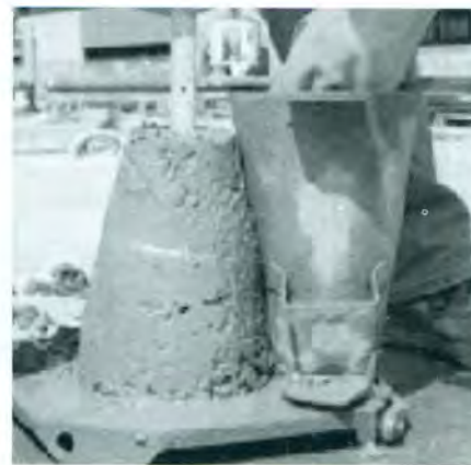
Figura 1. Ensayo de asentamiento (Cement Association of Canada).
