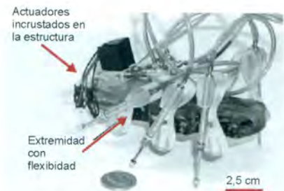
Figura 1. Sprawlita , hexápodo dinámicamente estable, resultado de las investigaciones en la locomoción de la cucaracha.
