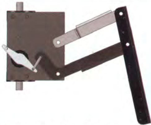
Figura 4. Mecanismo de seis barras de elevación de la extremidad.
