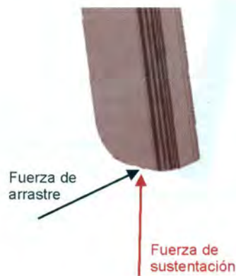
Figura 10. Detalle de las fuerzas ejercidas en el punto de apoyo de las extremidades con el piso.
