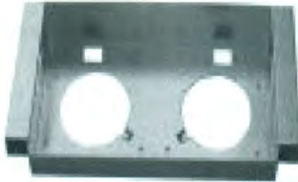
Figura 7. Estampación de chapa metálica.
