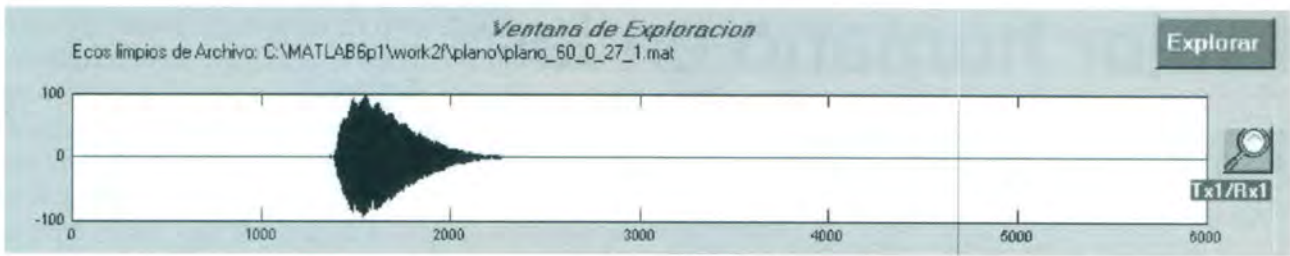
Figura 9. Señal resultante: discriminación del eco principal proveniente del obstáculo más cercano.
