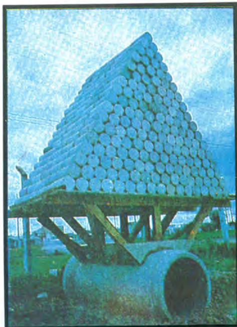
Tubo rígido TITAN® de 60 cm. de diámetro por 2 m. de longitud, bajo carga de 11,5 toneladas, sin soporte lateral.
