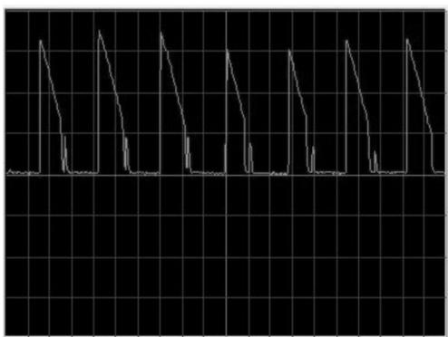
**Figura 46.** Tensión sobre la carga para voltaje de control  $V_c=3,0V$ .
