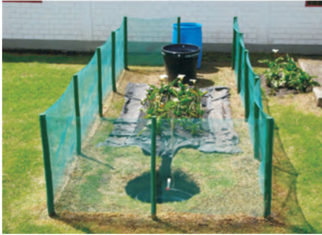
Figura 2. Humedal de flujo subsuperficial piloto.
