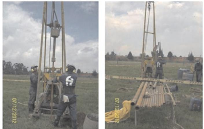
**Fotografía 1.** Equipo mecánico de percusión y lavado.
