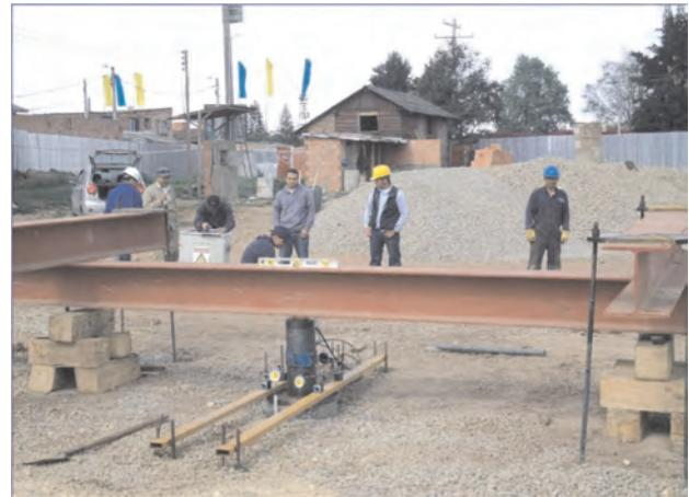
**Figura 10.** Montaje para la prueba de carga sobre una pila en la zona A.
