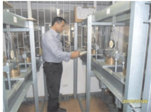
**Fotografía 5.** Consolidómetros de Suelos y Pavimentos Gregorio Rojas & Cía. Ltda. (En la fotografía, Gregorio Rojas toma lecturas en el proceso de ensayo de consolidación).
