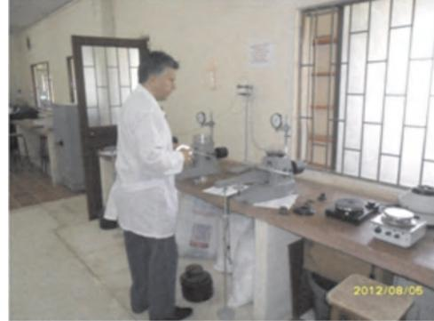
**Fotografía 4.** Consolidómetros de Uniagraria. (En la fotografía DMS, tomando lecturas en el proceso de ensayo de consolidación).
