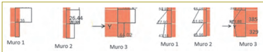
Figura 9. Comparación de cortantes y momentos en los muros 1, 2 y 3. Modelo interacción suelo-estructura. Corto plazo (ton).
