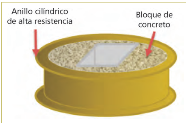
Figura 7 Esquema del montaje del aparato de esfuerzos poliaxiales, tipo bloque de concreto, envuelto en un anillo de acero de alta resistencia.
