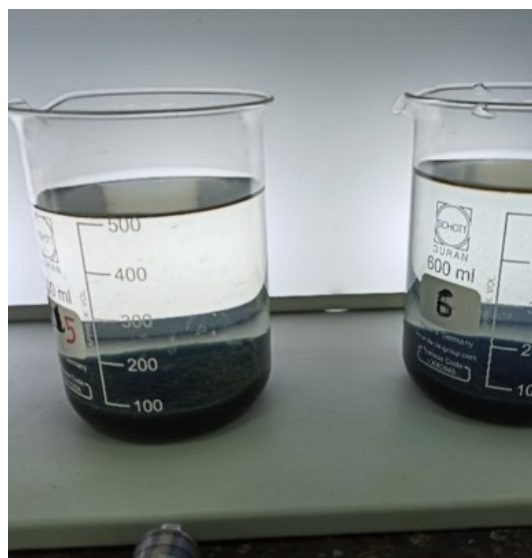
Figura 6. Agua clarificada al final de la sedimentación.
