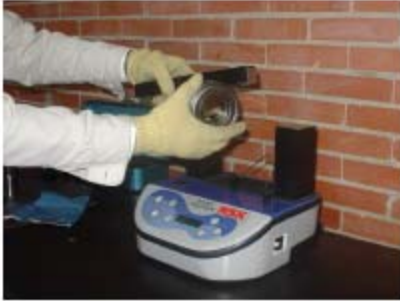
Figura 11: Retiro del rodamiento.
