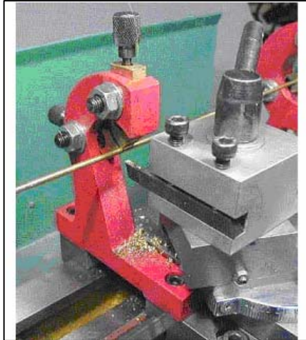
Figura 12. Luneta para Sujeción de piezas.
