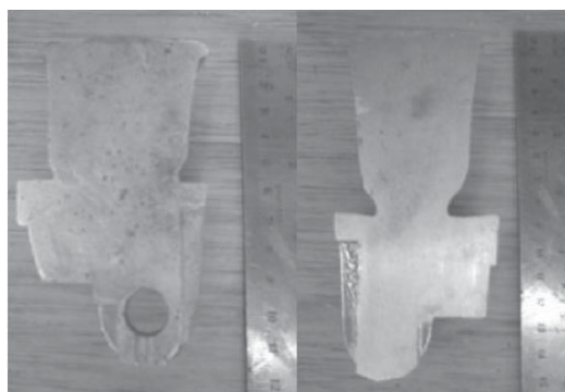
Figura 6. a) Pieza obtenida con defectos internos. b) Pieza obtenida sin defectos internos.
