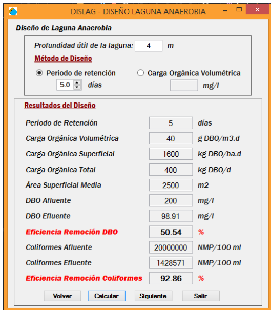
Figura 8. Diseño de laguna anaerobia Dislag.
