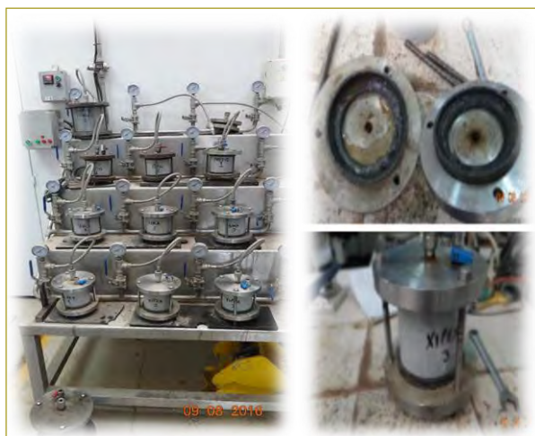
Figura 10. Características del montaje en la prueba de presión de agua ejecutada a las muestras de concreto.
