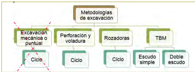
Ilustración 1. Metodologías de excavación. Fuente: Auditoría del autor.
