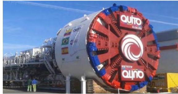
Ilustración 4. Sistema de perforación con máquina tuneladora TMB. Fuente: www.ubicatv.com/ecuador .
