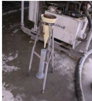
Fotografía 3. Cono de Marsh preparado para iniciar el ensayo de viscosidad.
