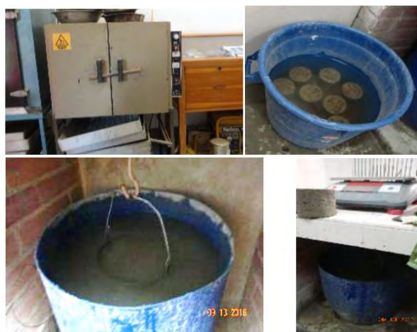
Figura 11. Procesos de saturación y secado para definir características de los elementos de concreto.
