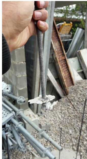
Figura 14. Falla por adherencia de anclaje \phi 3/8'' a profundidad de embebido igual a 2,5 veces el diámetro.
