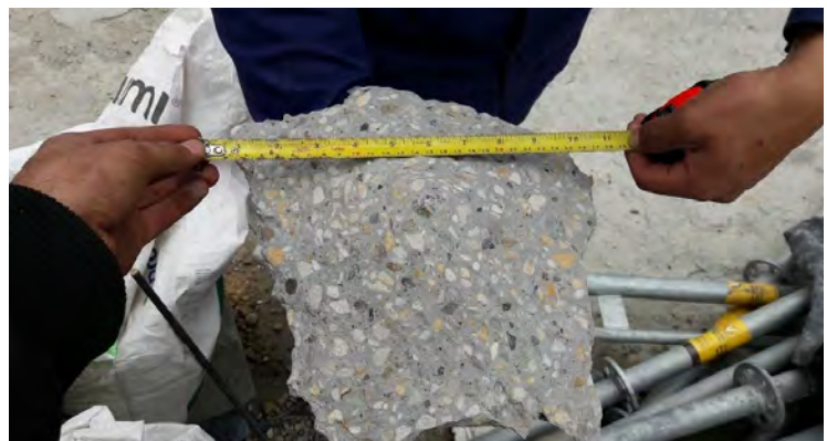
Figura 16. Falla por arrancamiento del concreto con extracción de anclaje \phi 5/8'' a profundidad de embebido igual a 5 veces el diámetro.
