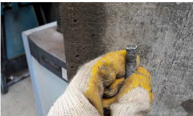
Figura 10. Anclaje \phi 1/2'' después de ensayo a corte. Falla del acero.
