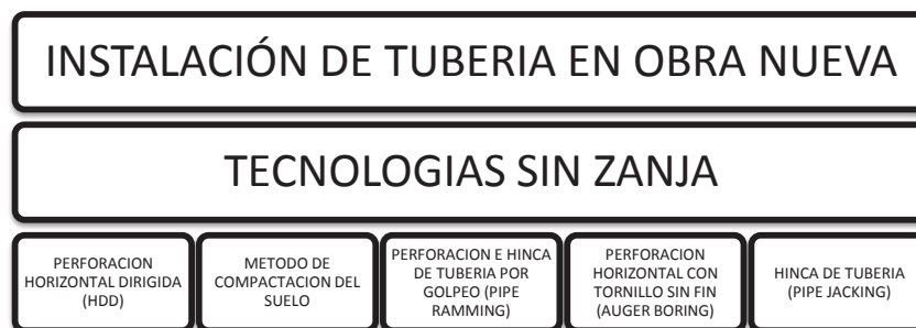
Figura 1. Tecnologías sin zanja para obra nueva.
