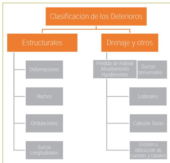
Figura 3. Clasificación de los deterioros mediante el método Viziret.
