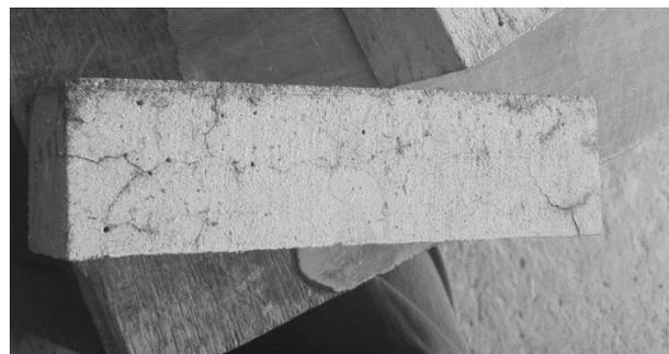
**Figura 8** Fisuración de viga de mortero debido a RAS.
