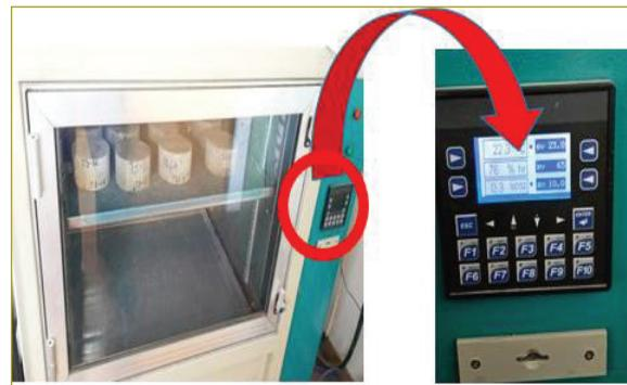
**Figura 7.** Cámara de carbonatación.
