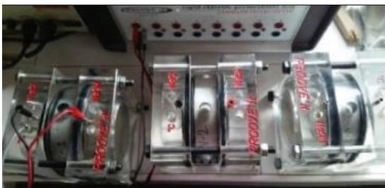
**Figura 6.** Foto de ensayo de penetración de cloruros.
