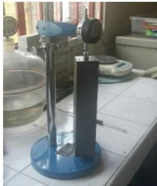
**Figura 7.** Ensayo de contracción del concreto.
