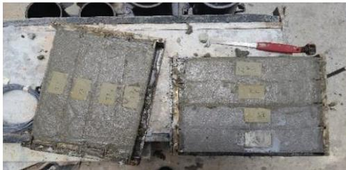
**Figura 8.** Moldes de las viguetas en estado fresco.
