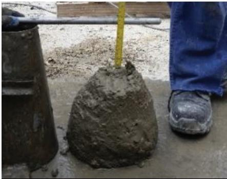
**Figura 1.** Ensayo de asentamiento.
