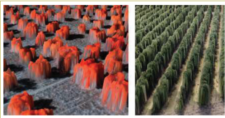
Figura 6. Estimación de las dimensiones de cultivos leñosos obtenida a partir de las imágenes adquiridas por un dron. Adaptada de [4].
