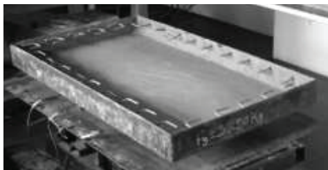
Figura 3. Formaleta metálica con ganchos laterales para restricción.
