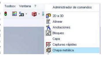
Seleccione el plano de planta para dibujar un croquis de 302mm X 475mm *centrado en el origen* y seleccione el icono de Brida/base, dele una configuración de 4mm de espesor a toda la chapa metálica que trabajará.
