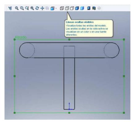
Seleccione el plano de alzada para dibujar la línea guía de la operación de saliente base/barrido.
