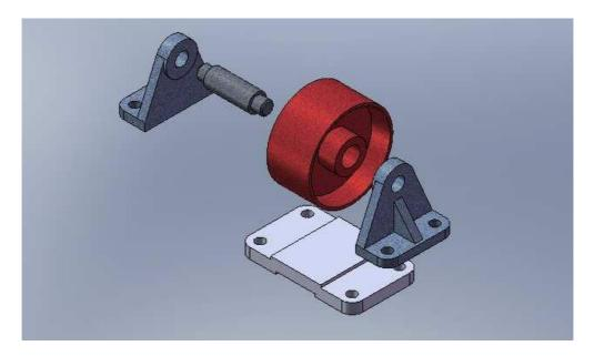
Para regresar a la vista inicial del ensamble deberá dar clic derecho sobre el icono de ensamble en el árbol de diseño y aquí seleccionar la opción de colapsar.
