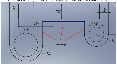
Acote la nueva línea horizontal con uno de los lados inferiores de uno de los dos rectángulos y establezca una medida de ¾".
