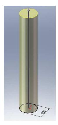
Para iniciar con esta pieza se deberá dibujar un circulo de 25mm de diámetro sobre el plano de planta y generar una extrusión de 150mm, el circulo deberá estar centrado sobre el origen para de pues poder usar este como referencia para operaciones posteriores.
