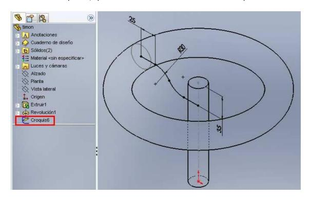
El siguiente paso será dibujar una elipse con centro en el extremo final del croquis anterior, sobre la línea de referencia para la operación de revolución.
