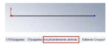
En la parte inferior de la pantalla de diseño se indicara el estado de la línea con respecto a sus grados de libertad.
