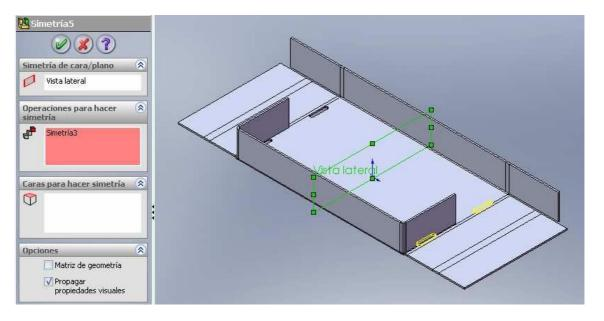
Una vez realizada esta simetría tendrá cuatro cortes ovalados sobre la cara inferior de la caja, estos cuatro cortes servirán de alojamiento para cuatro pestañas que se crearan posteriormente.
