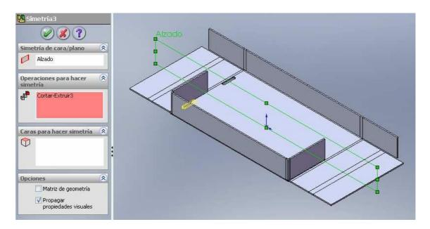
De nuevo seleccione el comando de insertar simetría para copiar la simetría que genera los dos cortes pero ahora utilizando como plano de referencia el plano de Vista lateral.
