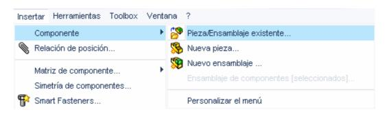
Seleccione el link examinar y busque la pieza Soporte Eje para insertarlo en la ventana de trabajo, de un clic dentro de la ventana de trabajo para ubicar la pieza seleccionada.
