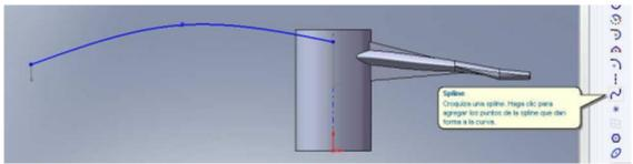
Utilice el comando de recubrir, en la ventana de perfiles seleccione los croquis de rectangulares que creo, seleccione la spline como línea guía de la operación.
