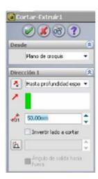
Seleccione la cara inferior del cuerpo cilíndrico central para realizar una operación de Extruir corte. La distancia del corte será de 50mm.
