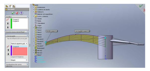
Inserte una operación de redondeo sobre la arista superior del cuerpo central. El radio de redondeo será de 10mm.
