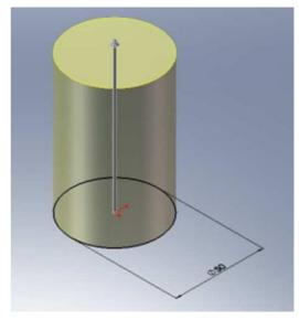
Dibuje una elipse tal como se muerta en el boceto, agregue una relación de coincidencia entre el centro de la elipse y el eje central del cilindro.
