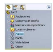
Seleccione el plano de trabajo según la forma de la figura, una buena elección del plano de trabajo facilitara posteriores operaciones.
