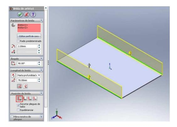
Con estas dos pestañas creadas genera las dos pestañas laterales que hacen falta utilizando el mismo comando pero con la siguiente configuración. Coloque un radio de curvatura de 2mm.
