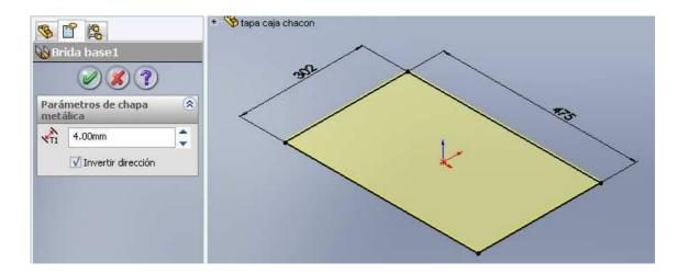
Con la chapa base creada, se comenzará a crear las pestañas que darán forma a la caja para esto seleccione las dos aristas laterales mas largas y utilizando el comando de Brida de arista, darles un radio de doblado de 2mm un ángulo de 90 grados y una longitud de 78mm. En la configuración de posición de brida seleccione la opción de material interior lo cual hará que la pestaña creada se proyecte dentro de la chapa base.
