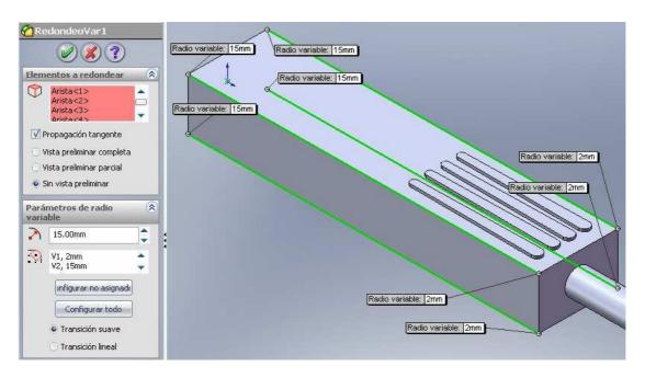
Seleccione la arista inferior del cepillo para realizar otra operación de redondeo, en este caso con un radio 8mm constante de y con la opción de propagar por la tangente.
