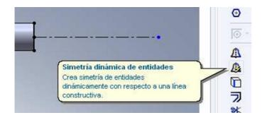
**TRUCO**: Utilice el comando de simetría dinámica de entidades para hacer que todo lo que dibuje a un lado de la línea de referencia se refleje automáticamente al otro lado.
