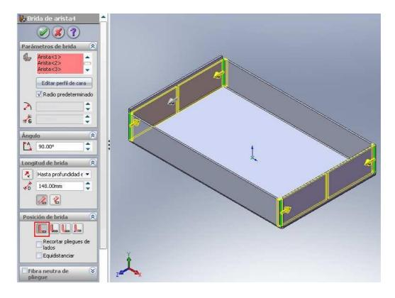
Para generar un dobles en forma de U seleccione el comando Dobladillo en la barra de chapa metálica. Seleccione las dos aristas exteriores de las pestañas laterales y entre los parámetros siguientes longitud de dobles de 80mm separación entre caras interiores del dobles de 7mm.
