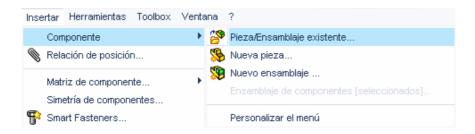
Seleccione el link examinar y busque la pieza Soporte Eje para insertarlo en la ventana de trabajo, de un clic dentro de la ventana de trabajo para ubicar la pieza seleccionada.
