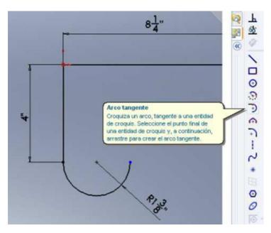
Seleccione el comando arco tangente para dibujar media circunferencia con un radio de 1 3/8", primero seleccione el comando arco tangente, pique el extremo inferior de la línea de 4", mueva el cursor hacia la derecha de la línea y ubíquelo en una posición similar a la mostrada.
