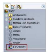
Para esta pieza seleccione el plano de planta para realizar el croquis que posteriormente se utilizara para crear la extrusión.
