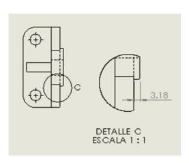
Para cambiar la escala de la vista de detalle o cualquier otra vista seleccione la vista y en el menú de la izquierda busque la opción escala.
