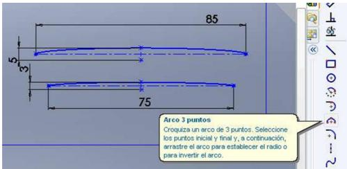
Dibuje una línea de referencia vertical que pase por los centros de los dos tramos de elipses que dibujó. Active el comando de simetría dinámica de entidades.
