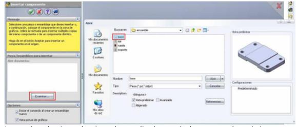
Luego de seleccionar la pieza de un clic dentro de la ventana de trabajo para ubicar la pieza inicial.
