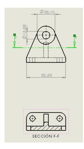
La dirección de la flecha indica la dirección en la que se observa el corte para cambiar la dirección de doble clic sobre el extremo de la flecha.
