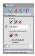
Seleccione de nuevo el plano de Alzada para dibujar una línea en posición similar a la siguiente, seleccione el comando de nervio. Dele un espesor de 8mm y active la opción de invertir lado de material.
