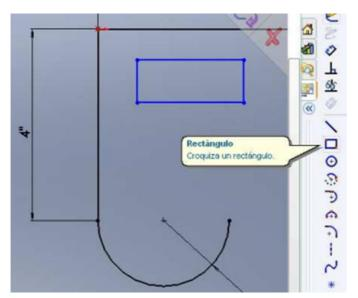
Utilice el comando de rectángulo para dibujar un rectángulo ubicado y con las proporciones que aparecen en el esquema.
