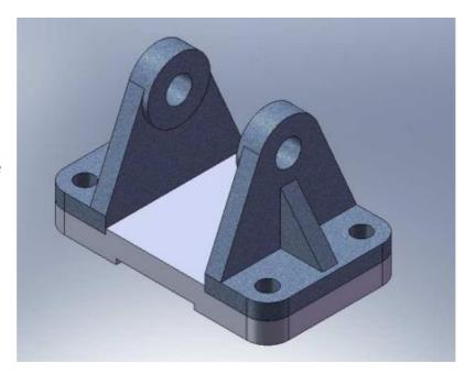
Luego establezca la relación coincidencia entre la cara superior de la base y la cara inferior del soporte para dejar totalmente fijo en segundo soporte.
