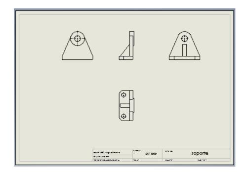
Para insertar otras vistas de la pieza seleccione el menú de Insertar Vista de dibujo y seleccione el tipo de vista que quiera utilizar.
