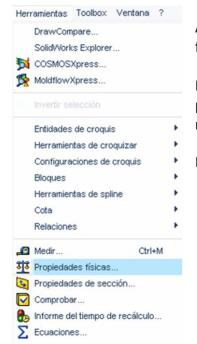
Al configurar el material se podrán calcular las propiedades físicas del sólido modelado.
