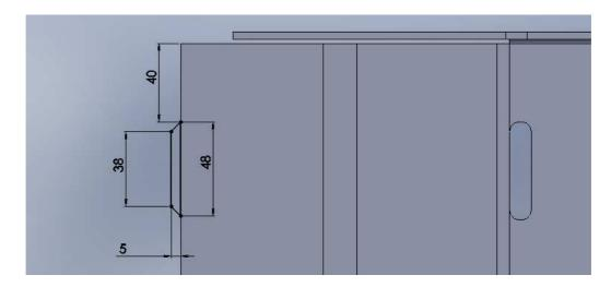
Con este croquis genere una operación de extruir hasta la superficie, utilizando como cara de referencia el respaldo de la chapa sobre la cual dibujo el croquis. Esto hará que la pequeña pestaña creada tenga el mismo espesor de toda la pieza.
