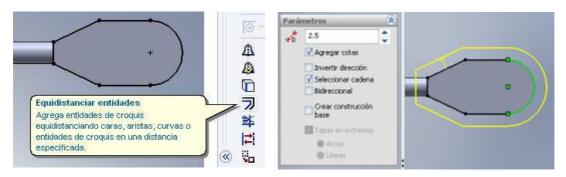
De una distancia de 2.5mm en los parámetros de la equidistancia y pique el interior de la cabeza para indicar la dirección hacia la cual se crearan las nuevas líneas del croquis. Genere una extrusión de 3mm utilizando el nuevo croquis.
