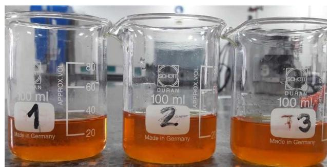
**Figura 6.** Muestra 4. Dosis 4: 47,7 g/L de  $H_2O_2$  y 3,57 g/L –  $Fe^{++}$  (28/11/2018).
