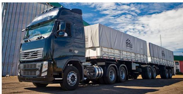
Figura 5. Combinación vehicular C3S2S2<sup>35</sup>.
