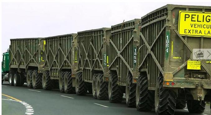
**Figura 8.** Tren cañero por una carretera nacional (nótese que los remolques utilizan neumáticos para uso exclusivo fuera de carretera, *off road*)<sup>46</sup>.
