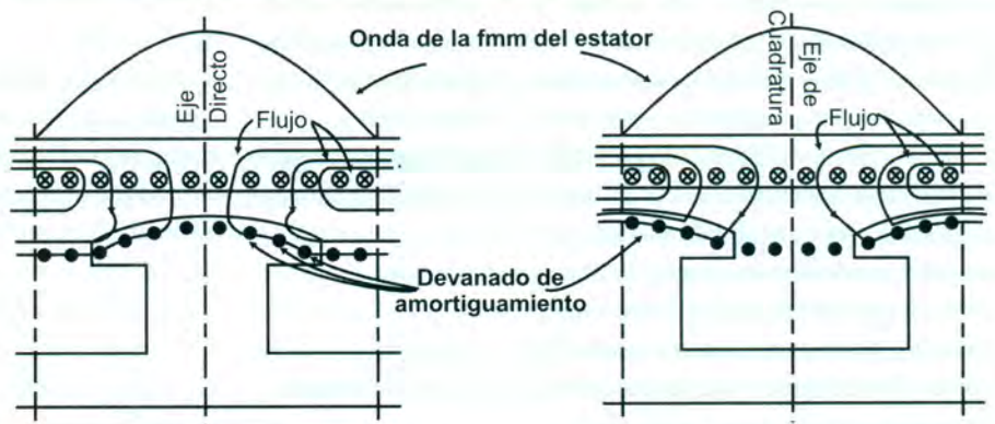
Figura 3. Efecto de reacción de armadura en eje directo y de cuadratura en estado subtransitorio [1].
