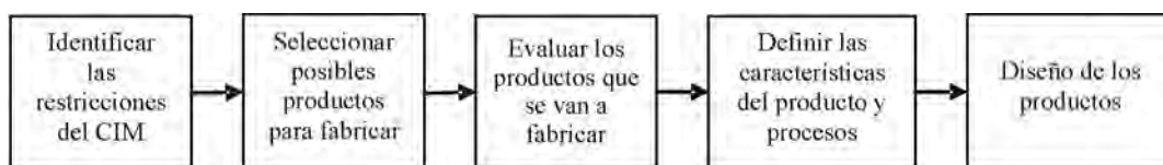
Figura 1. Proceso seguido en el diseño de los productos de la fábrica modelo.
