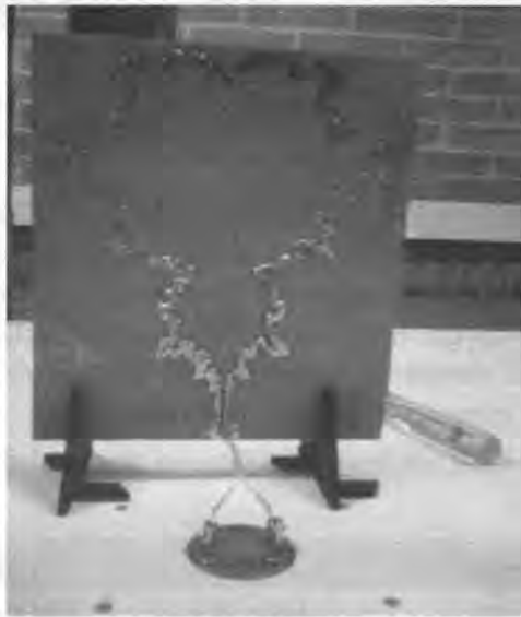
Figura 9. Antena fractal de Mandelbrot Z^2 + C con 16 iteraciones conectada a ASD512 Antenna Systems Demonstrator - Feedback.
