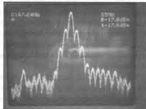
Figura 11. Portadora a 167,24 MHz radiada a través de la antena fractal de Mandelbrot, con diez iteraciones y visualizada en el analizador de espectros HM5012/14.
