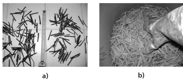
Figura 3. a) Tiras de caucho de 50 mm x 4 mm x 2 mm (T.C.). b) Mezclado de las tiras de caucho con pasta de cemento.
