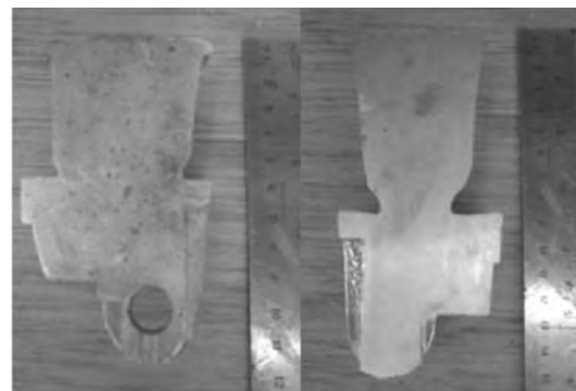
Figura 6. a) Pieza obtenida con defectos internos. b) Pieza obtenida sin defectos internos.
