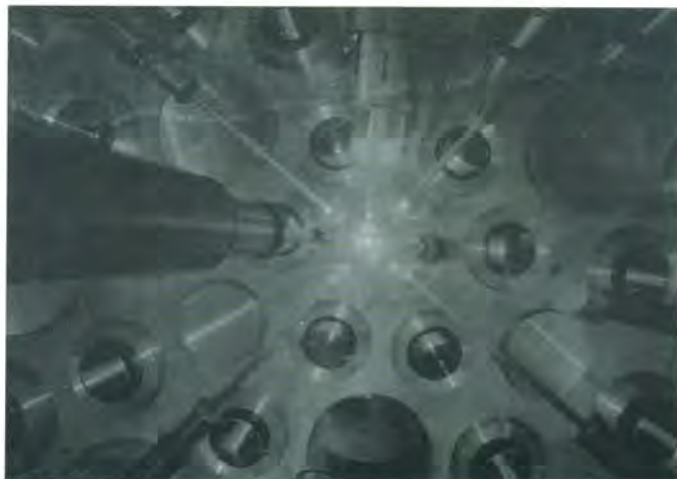
FIGURA 4. Láser Omega de la Universidad de Rochester irradiando la cápsula (en el centro).
