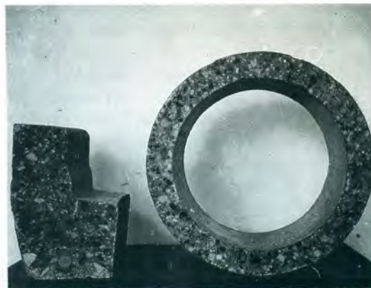
Cortes que muestran un Concreto Homogéneo y Durable
