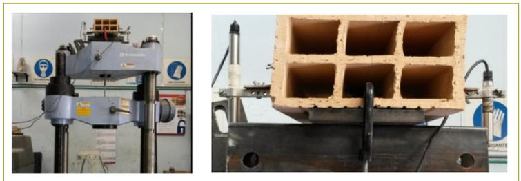
Figura 6. Armado para pruebas confinadas.
