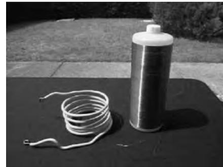
Figura 7. Construcción de los dos embobinados que conforman el circuito resonante.
